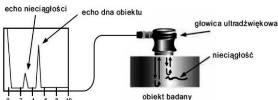
Rys. 1. Zasada przeprowadzania badania [1]
